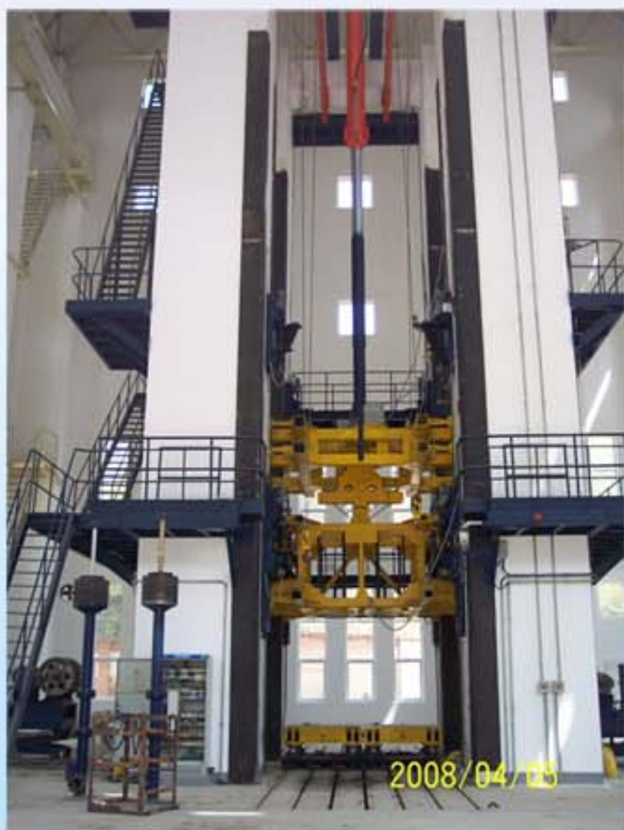
项目名称：落震试验台 承担工作：立项咨询、设备设计、设备总承包、工程总承包 设备特点：投放重量达到 120T
