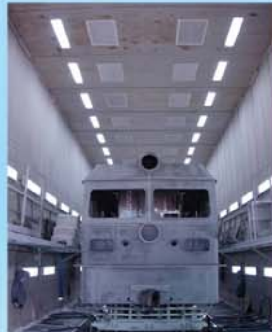
设备名称：机车车体喷砂室
