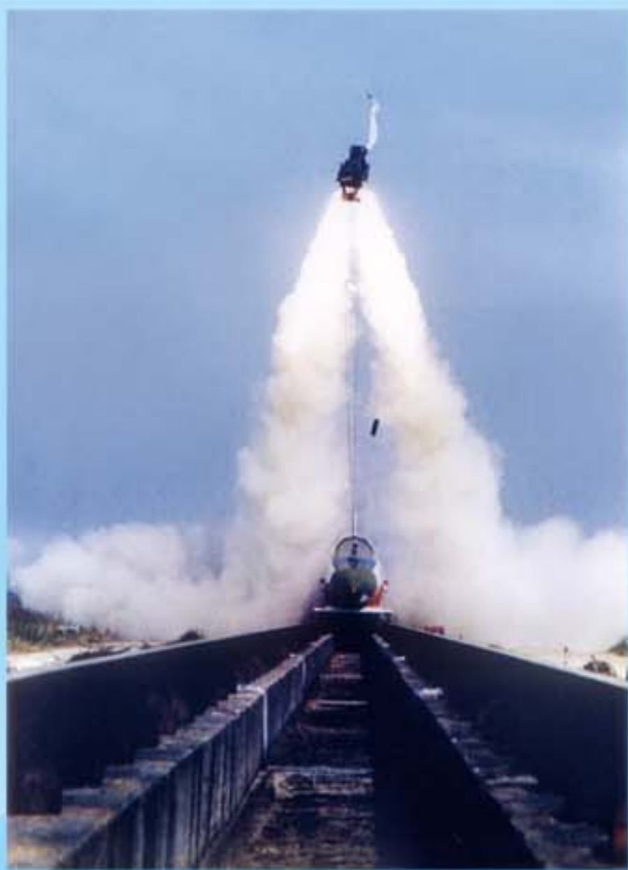
项目名称：火箭滑轨试验场 承担工作：立项咨询、设备设计、工程设计 设备特点：轨道线性精度世界一流基准线相对精度处于国际先进水平 获奖经历：国防科学技术进步二等奖
